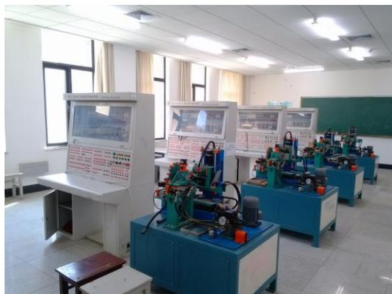
**HJD-4 型机电一体化教学实验系统**是购置的一种新型教学实验设备，它由 PC 机、电气控制系统和微加工中心机械平台及控制软件等组成。其中电气控制系统包括：PLC、变频调速器、交流伺服电动机及驱动、步进电动机及驱动、CJ1W-NC213 定位模块、PLC 与 PC 通信接口板、继电器和接触器及控制面板等。
