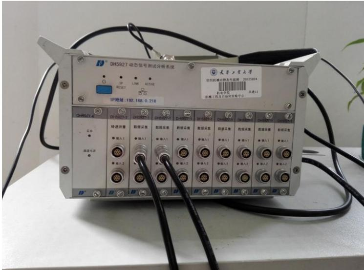
图 11 机械噪声振动测试系统
