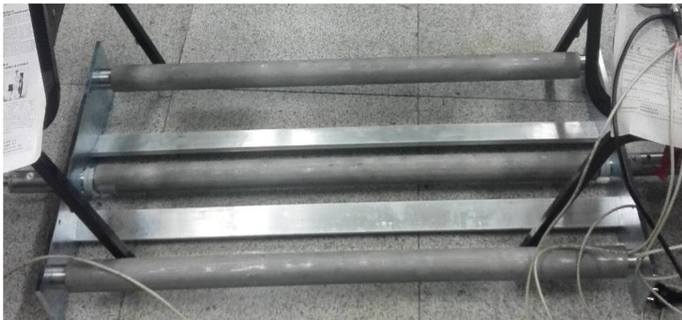
图 8 宽幅张力检测仪
