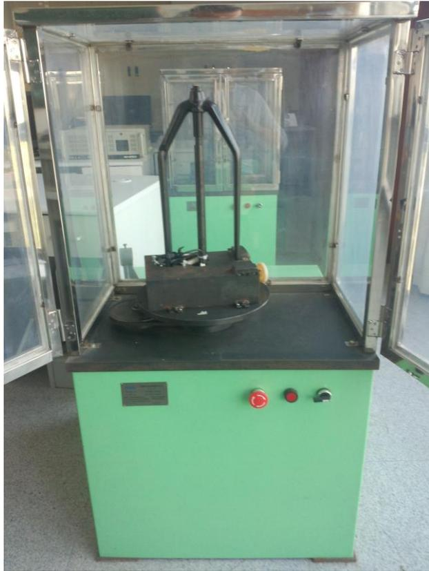
图 14 粗纱锭翼性能测试试验台
