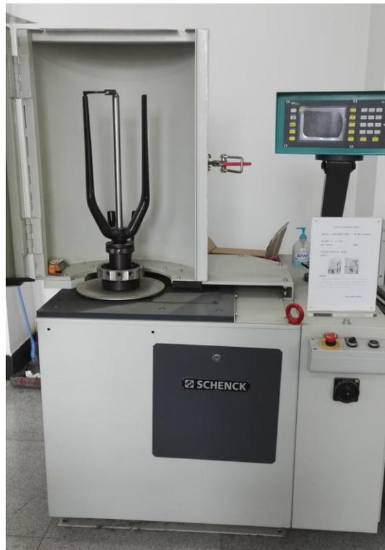
图 13 粗纱锭翼动平衡试验台
